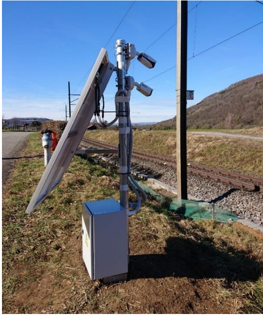
Abb. 8: Kamerasystem in Mellikon: Kameramast mit Weitwinkel- und Nahbereichskamera, Stromkasten mit Batterie und Router (links) sowie Solarpanel (rechts). © WLS.CH, 2020
