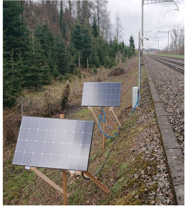
Abb. 10: Kamerasystem in Oberrüti: Kameramast mit zwei Nahbereichskameras, Stromkasten mit Batterie und Router (links) sowie zwei Solarpanel (rechts). Diese Strecke bestand aus zwei Gleisen. © WLS.CH, 2021
