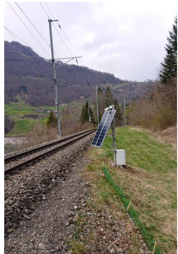
Abb. 11: Kamerasystem in Lungern: Kameramast mit Nahbereichskamera, Stromkasten mit Batterie und Router (links) sowie Solarpanel (rechts). © WLS.CH, 2021
