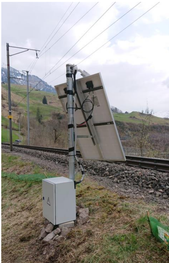
Abb. 11: Kamerasystem in Lungern: Kameramast mit Nahbereichskamera, Stromkasten mit Batterie und Router (links) sowie Solarpanel (rechts). © WLS.CH, 2021
