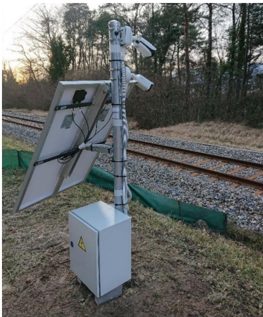
Abb. 9: Kamerasystem in der Grande Cariçaie: Kameramast mit Weitwinkel- und Nahbereichskamera, Stromkasten mit Batterie und Router (links) sowie Solarpanel (rechts). © WLS.CH, 2020
