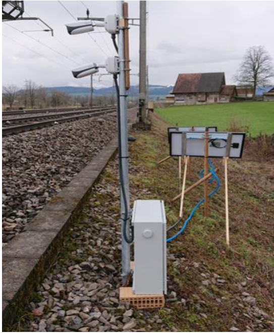
Abb. 10: Kamerasystem in Oberrüti: Kameramast mit zwei Nahbereichskameras, Stromkasten mit Batterie und Router (links) sowie zwei Solarpanel (rechts). Diese Strecke bestand aus zwei Gleisen. © WLS.CH, 2021
