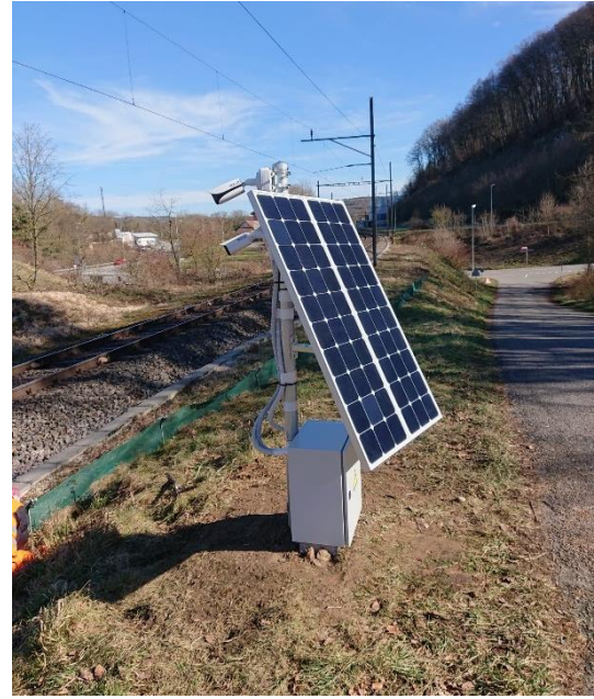
Abb. 8: Kamerasystem in Mellikon: Kameramast mit Weitwinkel- und Nahbereichskamera, Stromkasten mit Batterie und Router (links) sowie Solarpanel (rechts). © WLS.CH, 2020
