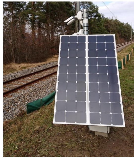
Abb. 9: Kamerasystem in der Grande Cariçaie: Kameramast mit Weitwinkel- und Nahbereichskamera, Stromkasten mit Batterie und Router (links) sowie Solarpanel (rechts). © WLS.CH, 2020
