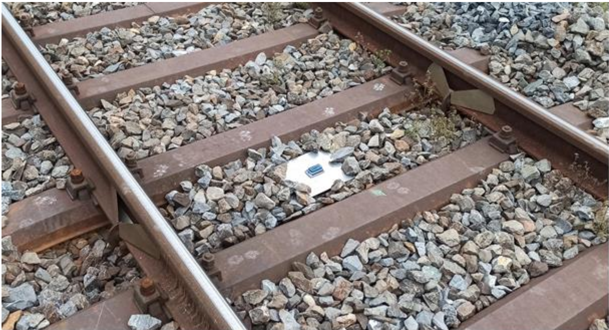
Abb. 27: MSR160 Data Logger auf Schotterhöhe im Gleiszwischenraum in Mellikon zur Messung eines potenziellen Luftdruckunterschieds auf Bodennähe bei Zugdurchfahrt. © Andrin Hunziker, 2021
