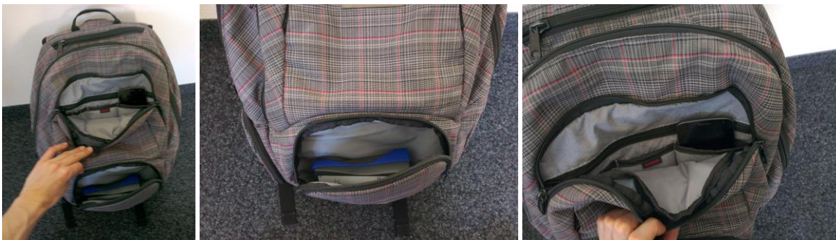
Figur 8: Messrucksack, der für den empirischen Teil verwendet wurde. Exposimeter (mittleres Bild) und Smartphone (Bild rechts) wurden in die Aussenfaschen versorgt. Beide Geräte befinden sich in einem Abstand von 15 cm oder mehr vom Körper.
