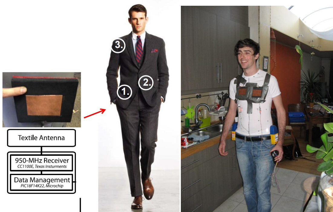
Abbildung 3: Mehrfachantennen Exposimeter (Personal Distributed Exposure Meter)
