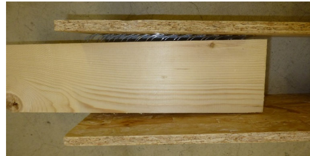
Abbildung 13: Tragwiderstand von Klammerverbindungen und OSB/3 im Vergleich inkl. Fotografien eines Prüfkörpers während dem Versuch sowie zwei typische, unterschiedliche Bruchbilder
