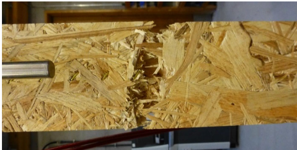
Abbildung 13: Tragwiderstand von Klammerverbindungen und OSB/3 im Vergleich inkl. Fotografien eines Prüfkörpers während dem Versuch sowie zwei typische, unterschiedliche Bruchbilder
