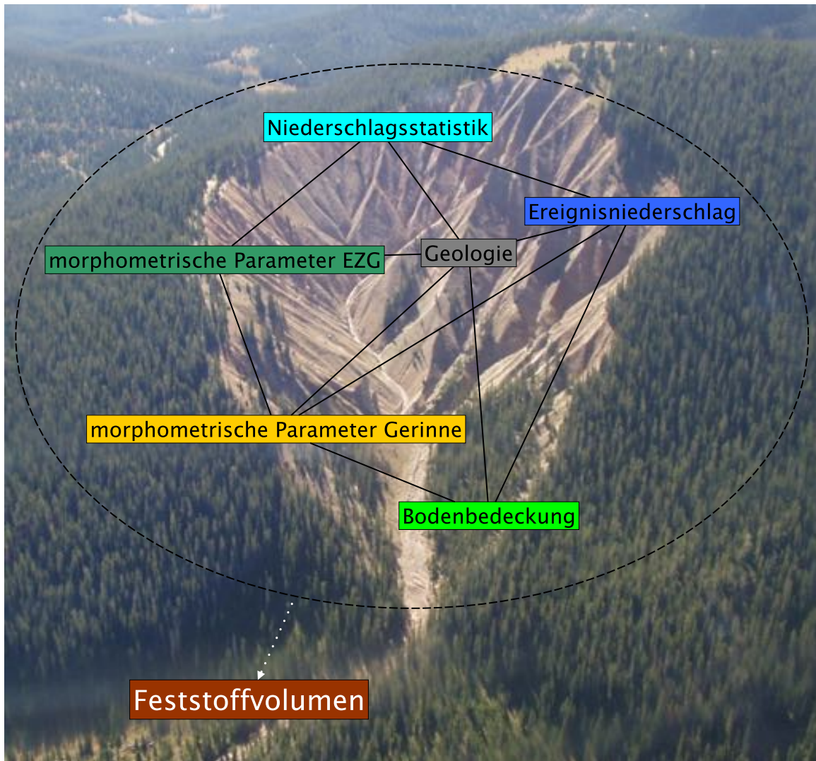
Abbildung 1-4: Konzeptmodell für die Abbildung der Feststoffführung in Wildbächen.
