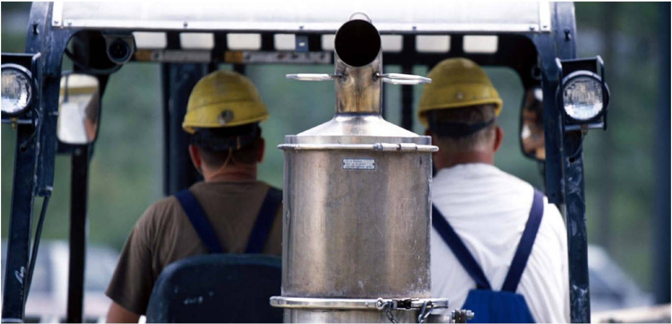
Partikelfilter auf einem Baustellengerät, NEAT-Baustelle in Amsteg (UR)
