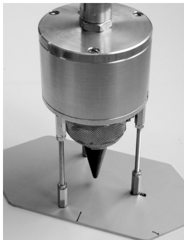
Abbildung 1: Modell-Lautsprecher. Die Schallaustrittsöffnung ist an der Spitze der kegelförmigen Struktur, etwa 3 mm über der Bodenplatte.
