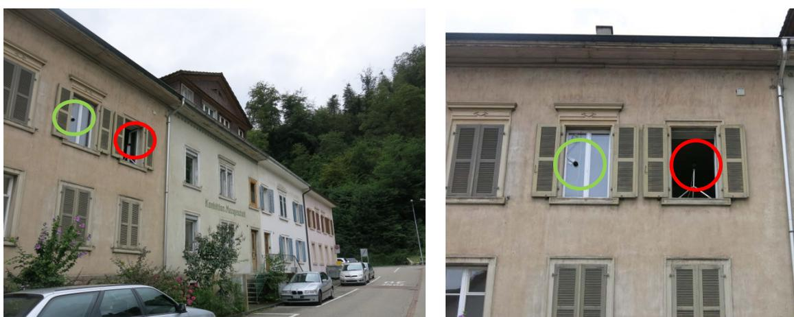
Abbildung 4: Freie Strasse 6: Strassenverkehrsmessung (30er-Zone) im offenen Fenster (roter Kreis) und in Grenzflächenmontage (grüner Kreis).
