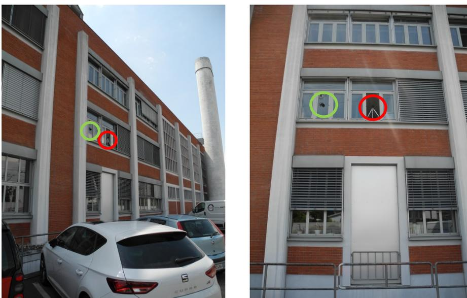
Abbildung 1: Bahnlärmmessung im offenen Fenster (roter Kreis) und in Grenzflächenmontage (grüner Kreis).
