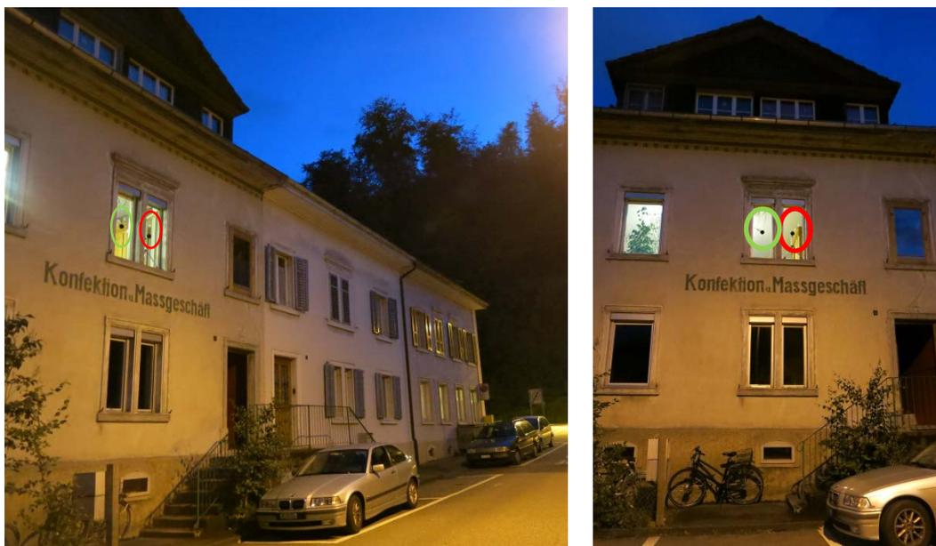
Abbildung 3: Freie Strasse 4: Strassenverkehrsmessung (30er-Zone) im offenen Fenster (roter Kreis) und in Grenzflächenmontage (grüner Kreis).
