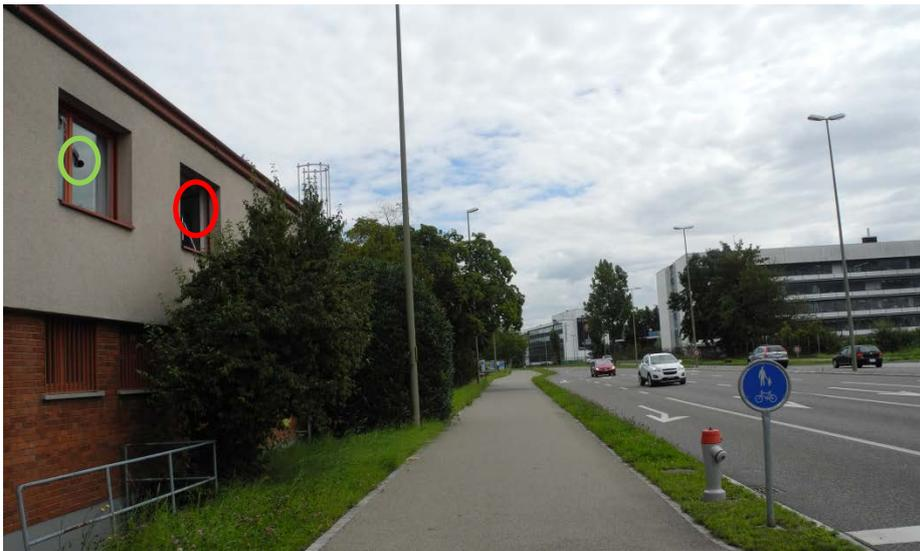
Abbildung 7: Dienstgebäude Empa: Strassenverkehrsmessung im offenen Fenster (roter Kreis) und in Grenzflächenmontage (grüner Kreis).
