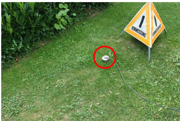
MP1 Referenzmesspunkt, 8 m ab 1. Gleisachse
