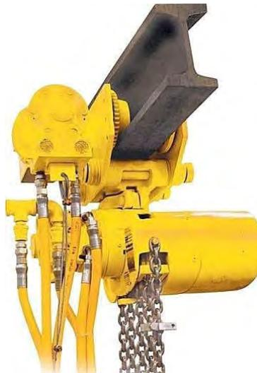
Abb. 14: Laufkatze einer Kranbahn, die gegen Absturz bzw. Abrutschen vom Kranträger gesichert ist (<http://www.directindustry.de>)
