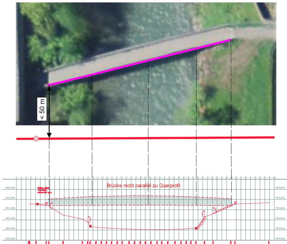
Abb. 26 Projektion der Brücke in ein weniger als 50 m entfernt liegendes Querprofil.
