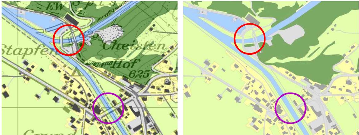
Abbildung 9: Zum Teil nicht enthaltene Brücken am Beispiel von Innertkirchen BE im Datensatz der amtlichen Vermessung. Links: PK25 und klassierte Daten zur Bodenbedeckung. Rechts: Klassierte Daten zur Bodenbedeckung.
