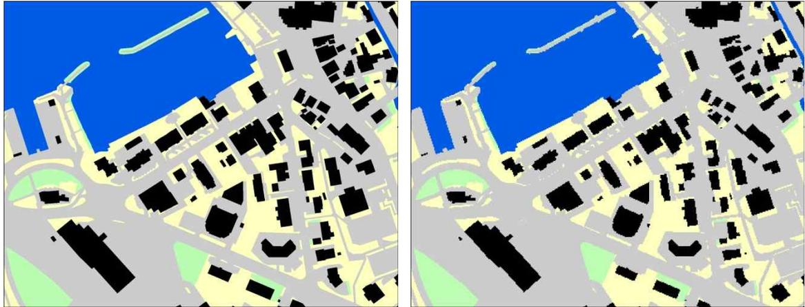
Abbildung 11: Vergleich zwischen der klassierten Bodenbedeckung: Vektordatensatz (links) und Rasterdatensatz (rechts) am Beispiel Stansstad (Kanton NW)
