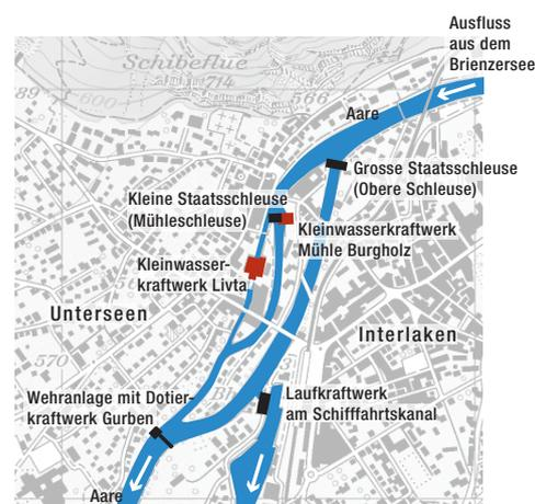
Im Normalfall erfolgt der Abfluss aus dem Brienersee über die beiden Kleinwasserkraftwerke Mühle Burgholz und Livta und dann – ab einer Wassermenge von  $26 \text{ m}^3/\text{s}$  – auch durch die Tore der Grossen Staatsschleuse. Die Kleine Staatsschleuse wird nur bei ausserordentlich hohen Abflüssen geöffnet (oder während Revisionsarbeiten an der Grossen Staatsschleuse).
