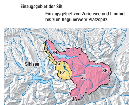
Bei der Seeregulierung müssen nicht nur die Abflussverhältnisse im Einzugsgebiet des Zürichsees (rot) berücksichtigt werden, sondern auch jene im Einzugsgebiet der Sihl (gelb).
