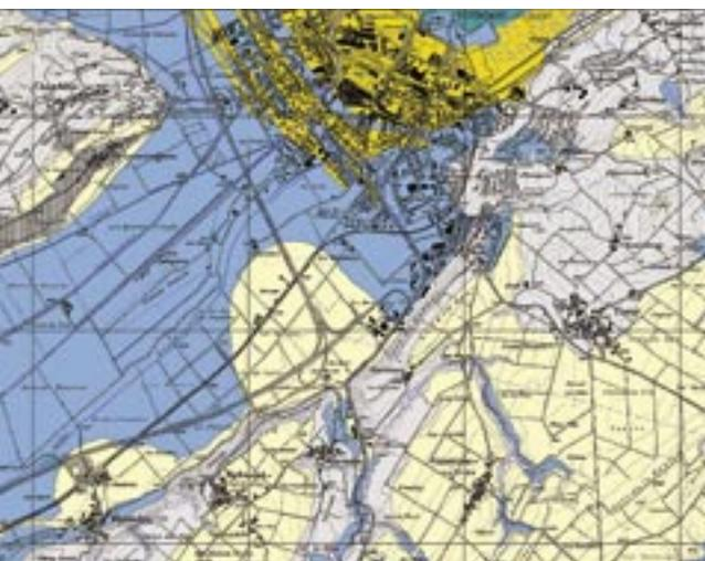
**Mit Hilfe der Mikrozonierung werden gefährdete Gebiete erfasst: Rhonetal bei Sitten VS, Messung der lokalen Erschütterungsfähigkeit in Aigle VD und Karte der Baugrundverhältnisse in der Umgebung von Yverdon-les-Bains VD.**
