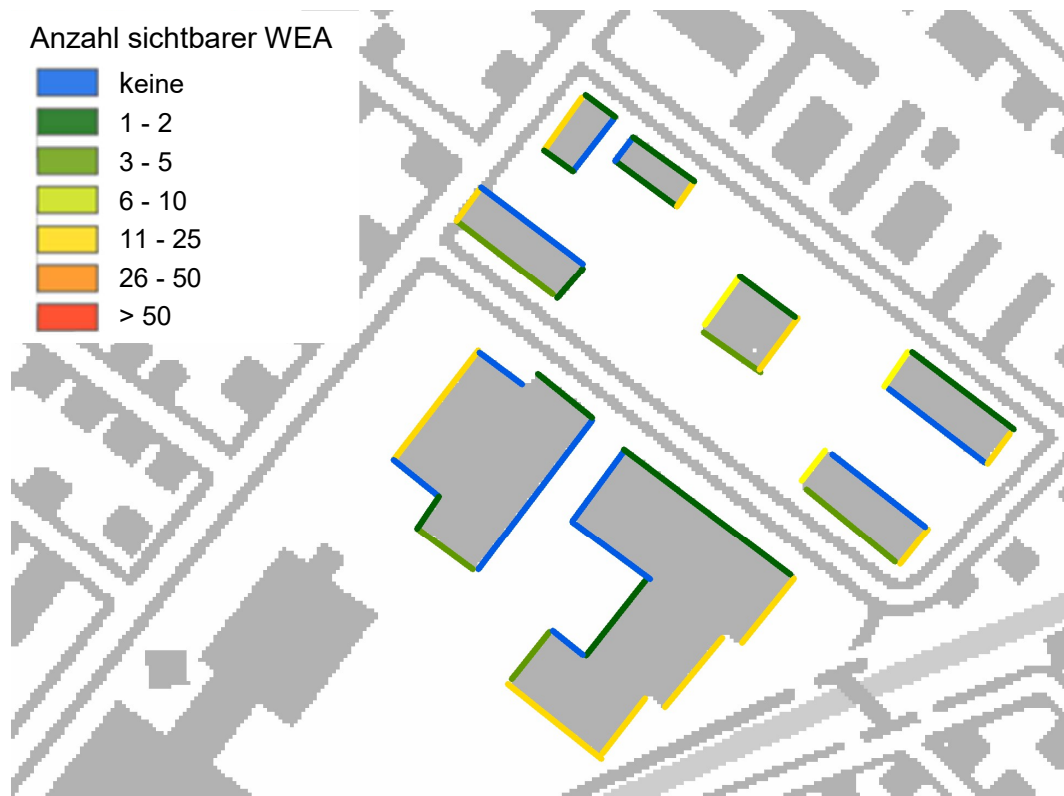
Abbildung 5: Beispiel einer Gebäudeanalyse auf Basis eines DOM.
