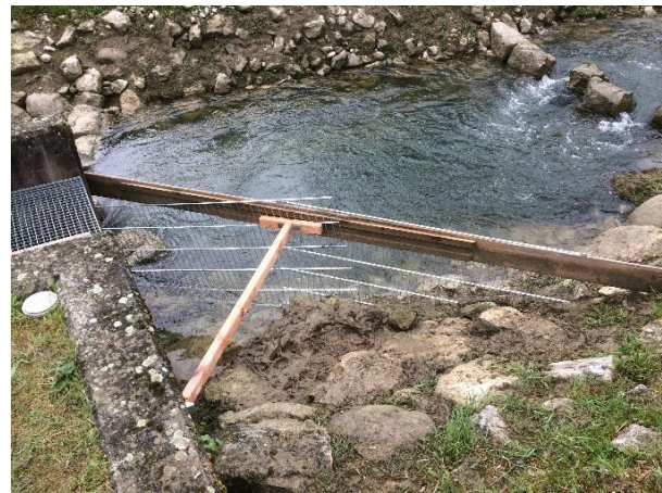
Abbildung 4: Tauchbalken und Rechen (vor dem Einbau des feinmaschigen Gitters) vor dem Einlauf ins Zählbeckens (Bildmitte links)
