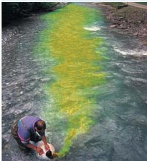
Die Markierung des Wassers mit Hilfe von künstlichen Tracern ist eine der wichtigsten Techniken in der angewandten Hydrologie und Hydrogeologie. Grundbedingung für eine korrekte Auswertung ist die einwandfreie Durchführung der Markierungsversuche. Bislang gab es jedoch keinen aktuellen, praxisnahen Leitfaden für diese Anwendung der Tracertechnik. Mit Unterstützung des BWG hat nun eine Arbeitsgruppe der Schweizerischen Gesellschaft für Hydrogeolo-
