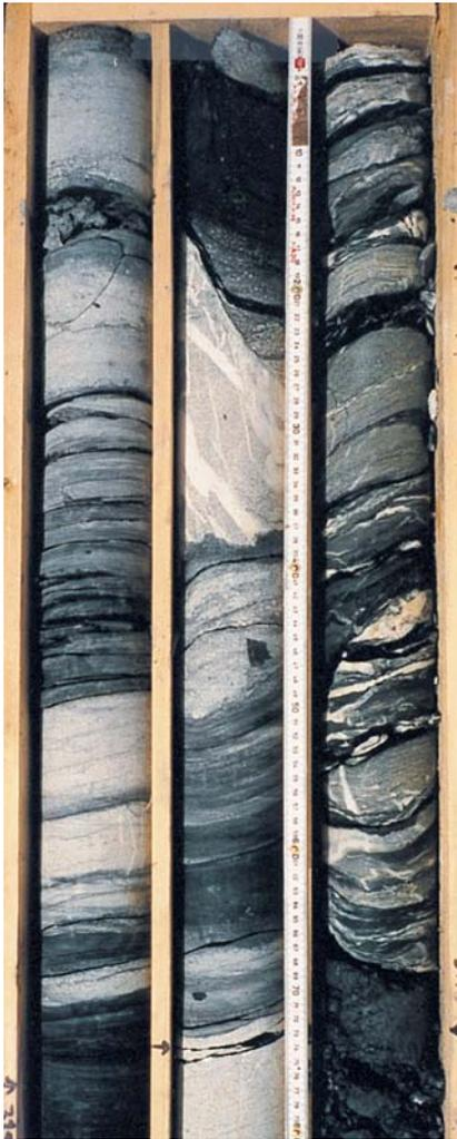
**Die Kerne einer Sondierbohrung geben den Geologen Aufschluss über die Zusammensetzung des Untergrunds.**
