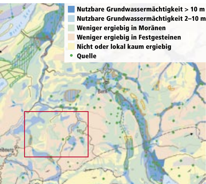
Die hydrogeologische Karte der Schweiz im Massstab 1:500'000 (Ausschnitt Mitte) macht unter anderem Angaben über die Ergiebigkeit der lokalen Grundwasservorkommen. Das Blatt Sarine/Saane 1:100'000 (rechts) stellt die regionalen Grundwasser- verhältnisse im Detail dar – hier am Beispiel der Gegend um Heitenried FR. Die Farbllegenden sind jeweils stark vereinfacht.
