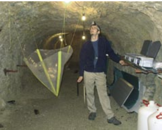
Einfärbung eines Bachs und Erfassung des versickerten Markierstoffs im Untergrund.
