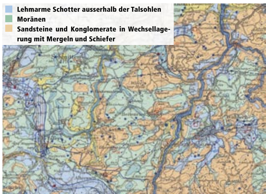
Die hydrogeologische Karte der Schweiz im Massstab 1:500'000 (Ausschnitt Mitte) macht unter anderem Angaben über die Ergiebigkeit der lokalen Grundwasservorkommen. Das Blatt Sarine/Saane 1:100'000 (rechts) stellt die regionalen Grundwasser- verhältnisse im Detail dar – hier am Beispiel der Gegend um Heitenried FR. Die Farbllegenden sind jeweils stark vereinfacht.
