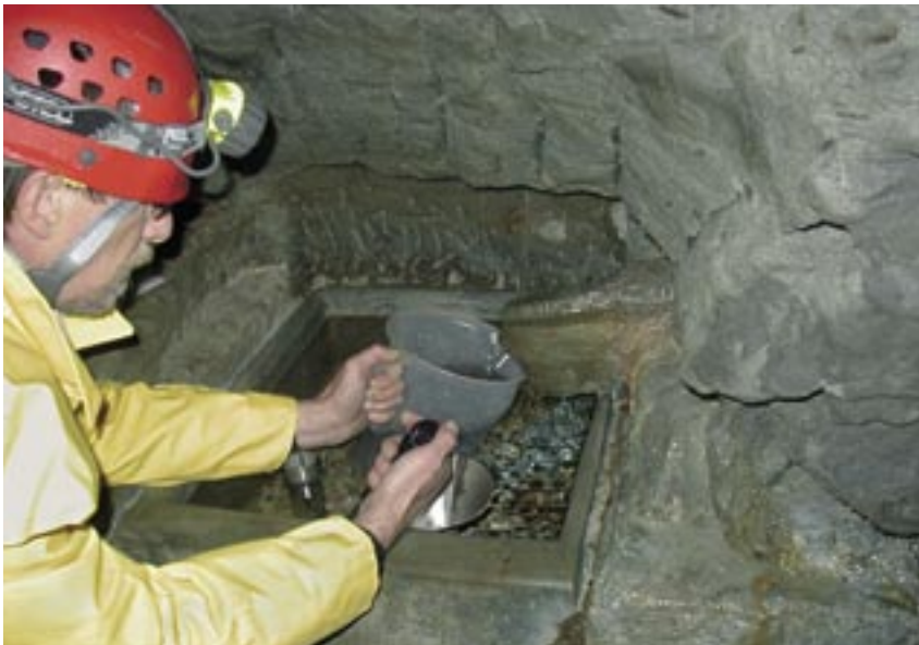
Messung der Schüttung einer kleinen Molassequelle (links). Der Standort ist Teil des NAQUA-Messnetzes zur Beobachtung des Grundwassers. Die Schichtabfolge im Lockergestein einer Kiesgrube im Berner Seeland (rechts) ist typisch für die Grundwasserleiter der grossen Flusstäler.
