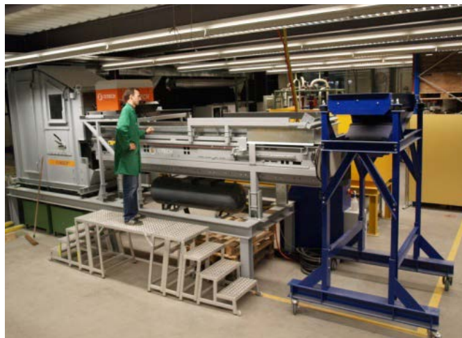
Abbildung 12: Sensorgestützter Finder der Firma TITECH im Technikum des UMTEC.
