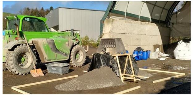
Figure 2 : Répartition et réduction des fractions minérales résiduelles en vue des analyses de laboratoire A et B
