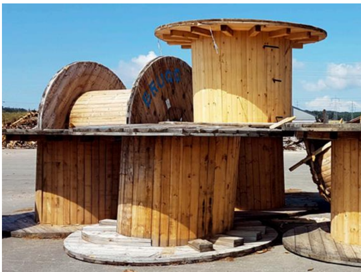
Illustration 2 : Non-bois de chauffage (selon l'OPair) et déchets de bois à problèmes (selon l'OLED), n'ayant pas le droit d'être brûlés dans des chaudières à bois ou à bois usagé. (Images issues du dossier Arbeitsbehelf 60 Altholzsortierung de l'ÖWAV)
