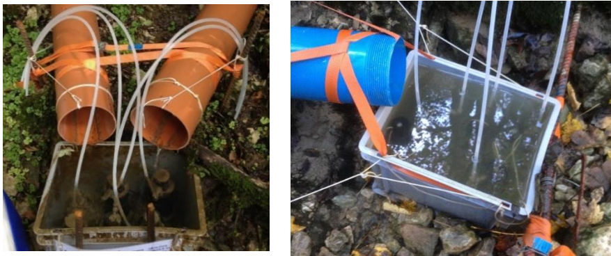
Figure 17 Exemple d'équipement de sources permettant d'assurer une profondeur d'immersion constante des capteurs passifs intégratifs de type Sorbicell. D'après (Renard et al. 2017).
