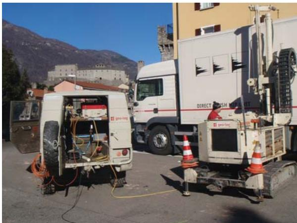
Les dépôts fins permettent de déterminer la pollution par «MIP» jusqu'au niveau de l'aquifère
