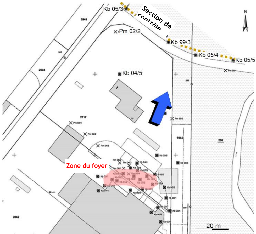
Figure 6-1: Points de mesure et étendue approximative du foyer (en rouge), section de contrôle, direction d'écoulement des eaux souterraines (flèche bleue) et points de mesure utilisés (écrit en grand)
