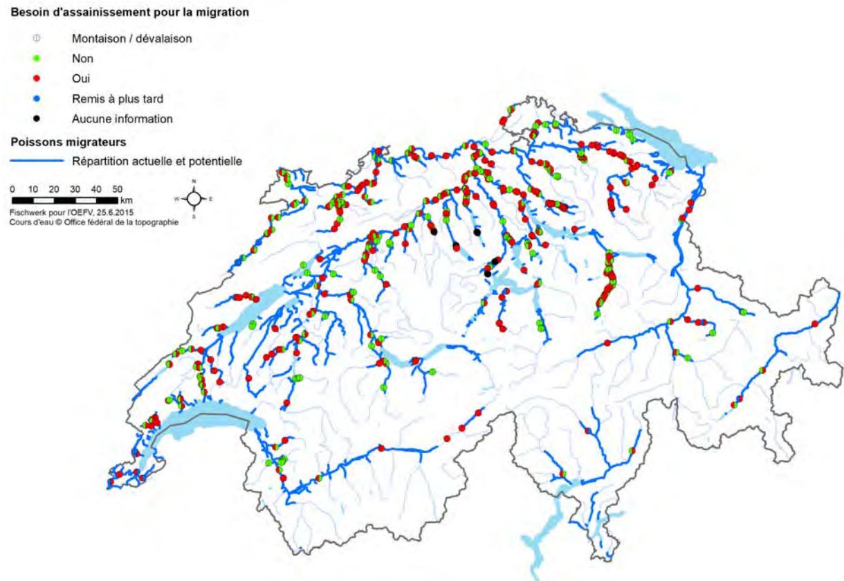
Fig. 4 Ouvrages hydroélectriques faisant obstacle à la migration et besoins d'assainissement pour rétablir les possibilités de migration vers l'amont ou vers l'aval dans les cours d'eau de répartition des espèces cibles (données OFEV, état de juin 2016).
