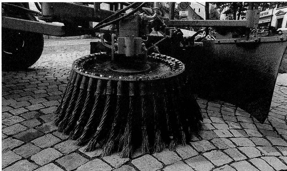
Cette sarcluse à brosse permet de lutter directement contre la croissance de plantes aux bords des routes, où celles-ci ne peuvent être tolérées. Ce modèle avec brosse en câbles d'acier permet d'éliminer la végétation haute, par exemple avant de procéder à un assainissement structurel.
