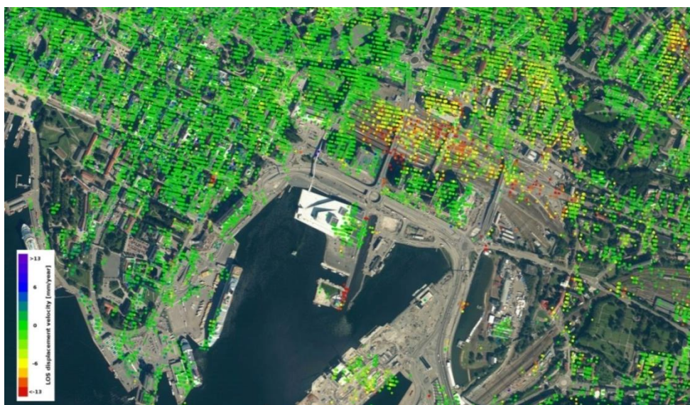
Figure 5 : Carte de l'affaissement du sol de la gare centrale d'Oslo. Les prises de vues réalisées lors de la mission Sentinel-1, le 26.12.2014 et le 28.10.2016, visualisent un affaissement annuel de la gare centrale variant de 12 à 18 millimètres. 28)
