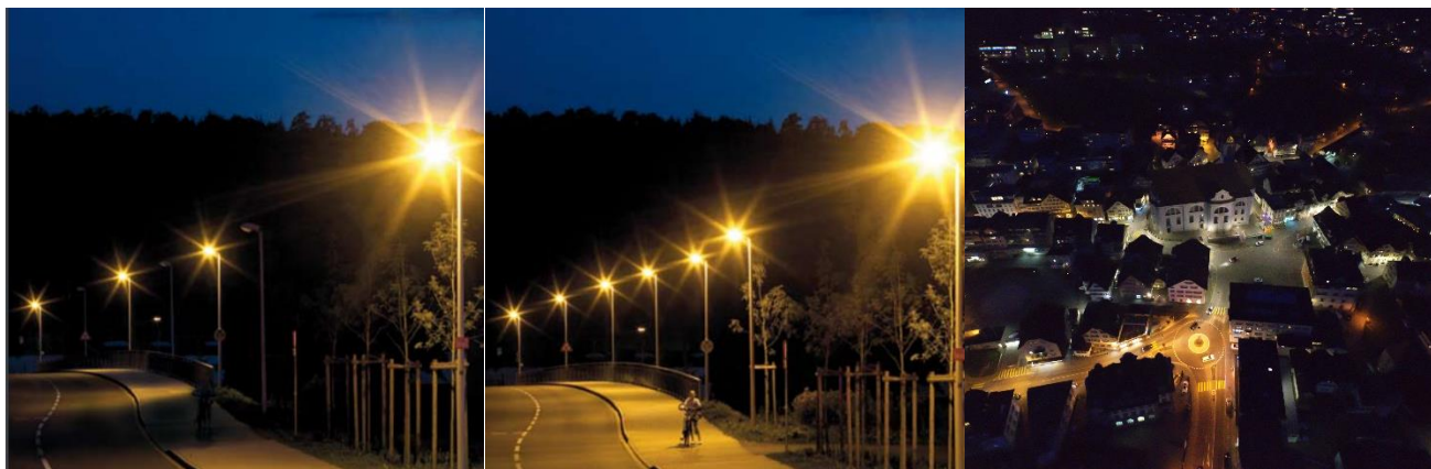
Figure 1 : Mauvaise visibilité due à l'extinction d'un luminaire sur deux (source : Trilux / licht.de)
