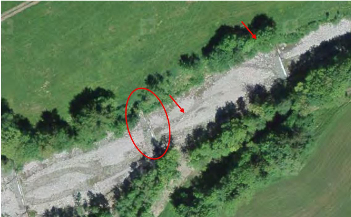
Abbildung 22: Referenzzustand ablagernde Bedingungen: Eher ablagernder Abschnitt am Hundschottenbach in Biberegg. Kreis: vergleichsweise kleine Kolke. Pfeile: grössere Blöcke. (Quelle: Swisstopop 2014).
