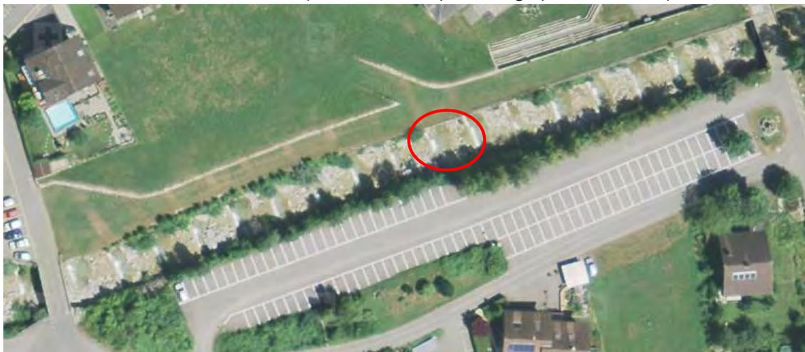
Abbildung 20: Referenzzustand geschiebearme Bedingungen: Ausgeprägte Kolke unterhalb von Sperren am Steinibach in Dallenwil im Abschnitt C. Kreis: Bsp. eines grossen Kolk der nahezu bis zur nächsten Sperre reicht. (Quelle: Swisstopo 2014).
