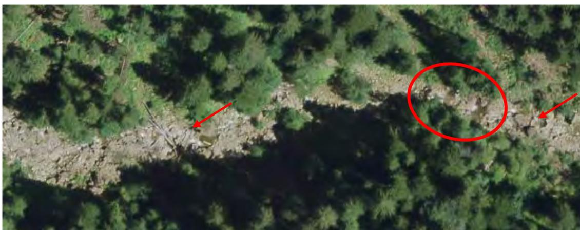
Abbildung 21: Referenzzustand umlagernde Bedingungen: Umlagerungsstrecke am Rotenbach in Plaffeien. Kreis: grössere Blöcke mit Kolken unterhalb. Pfeile: Ablagerung von grösseren Blöcken (Quelle: Swisstopop 2014).
