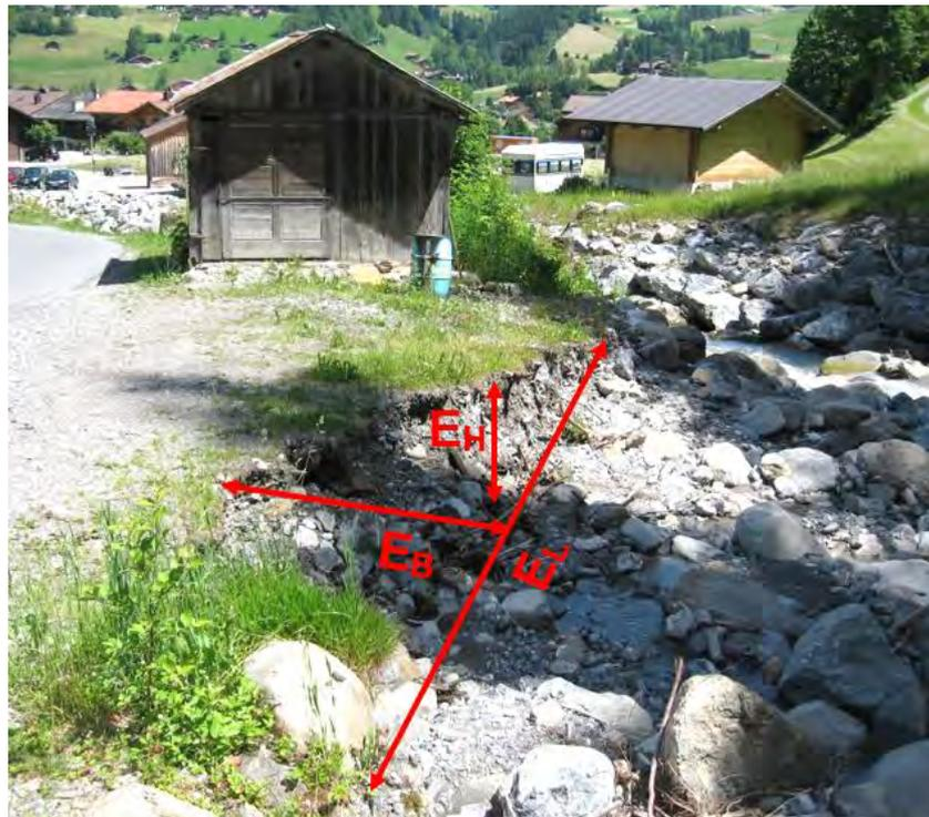
Abbildung 14: Parameter der Böschungserosion.  $E_B$  = Erosionsbreite,  $E_L$  = Erosionslänge,  $E_H$  = Erosionshöhe, Chalberhönibach in Saanen (Aufnahmedatum: 26. Juni 2015).
