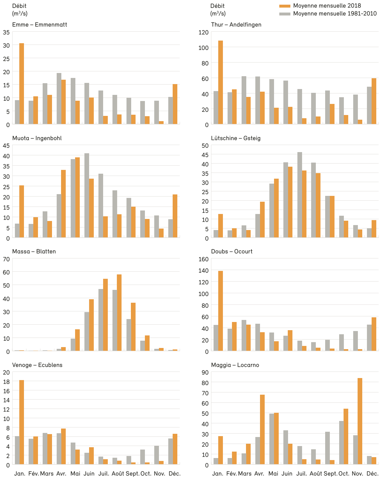
Fig. 4.4: Moyennes mensuelles 2018 des débits (orange) par rapport aux moyennes mensuelles de la période de référence 1981-2010 (gris)
