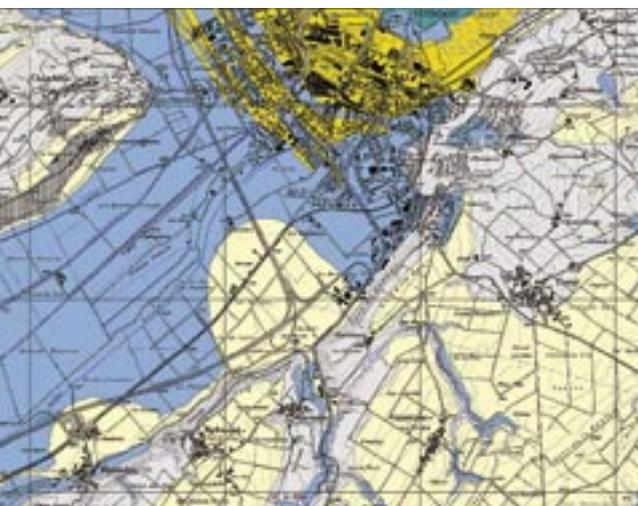
**Les zones menacées sont recensées à l'aide du microzonage: vallée du Rhône à Sierre VS, mesures des fréquences propres locales du sol à Aigle VD, et carte des sols de fondation dans les environs d'Yverdon-les-Bains VD.**
