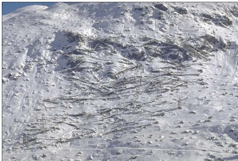
Figure 8: Placette d'essai du WSL dans la région de Disentis (1400–1500 m), le 25 février 1999 (neuf ans après Vivian), recouverte d'une épaisseur de neige de 150 cm. En moyenne, les troncs de la partie laissée telle quelle (milieu de l'image) accusaient une hauteur d'action de près de 120 cm (photo: W. Frey, WSL).
