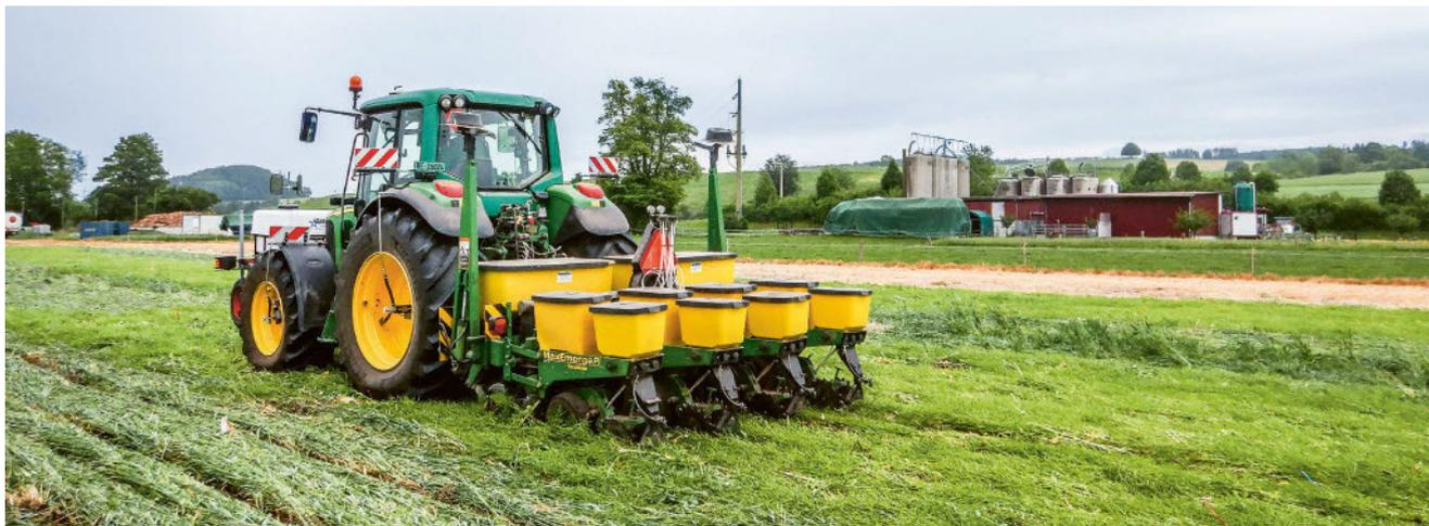
Semis de maïs au moyen d'un semoir dit de semis direct. Cette méthode évite la destruction de la structure du sol et de la couche végétale protectrice.
