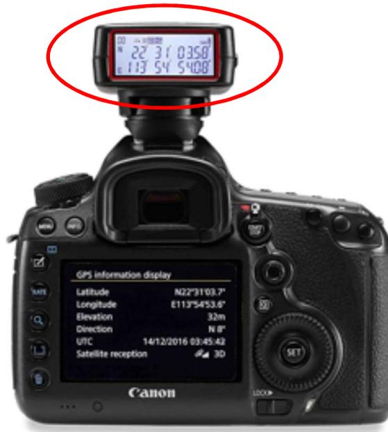
Figure 9: Appareil photo professionnel avec géomarqueur installé
