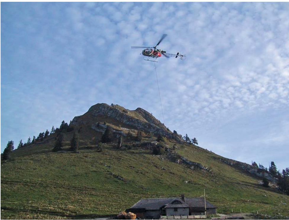
Fig. 4 > L'hélicoptère est très utilisé dans les travaux en altitude. S'il permet de limiter les atteintes au sol (pas de piste de chantier, p. ex.), il représente un facteur important de nuisance sonore.
