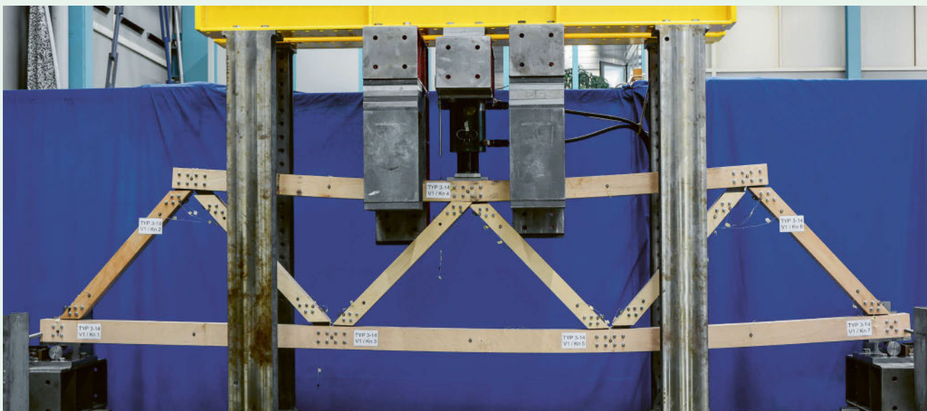
Test de résistance de treillis en placages de hêtre stratifiés
