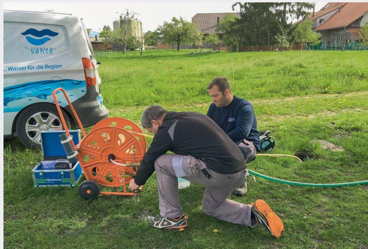
Prélèvement d'un échantillon d'eau souterraine pour la surveillance de la qualité de l'eau brute dans le bassin versant agricole d'un captage d'eau potable dans le Seeland bernois par les employés d'une entreprise de services publics.
