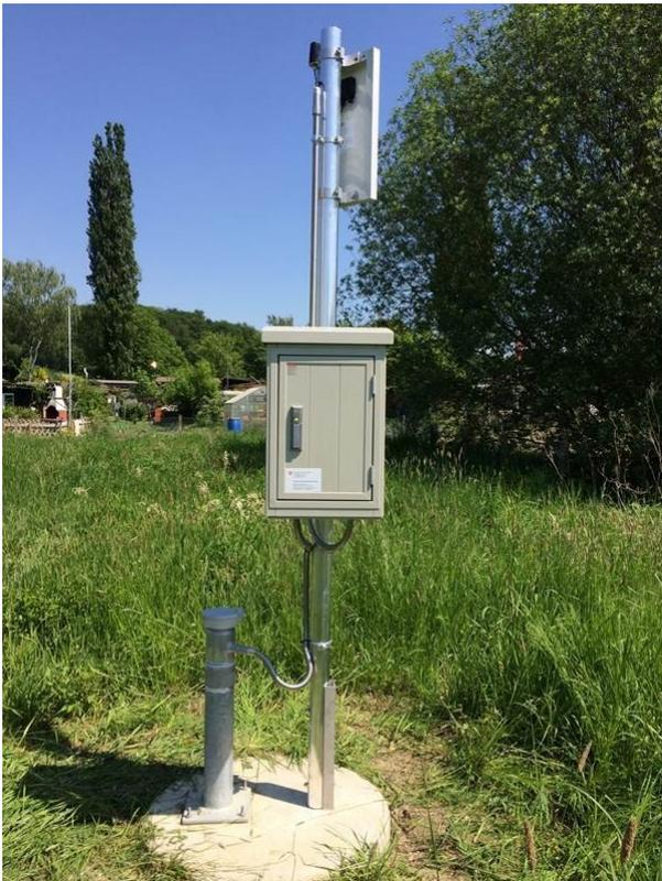
Station de mesure NAQUA-QUANT équipée d'un piézomètre pour observer le niveau des eaux souterraines.
