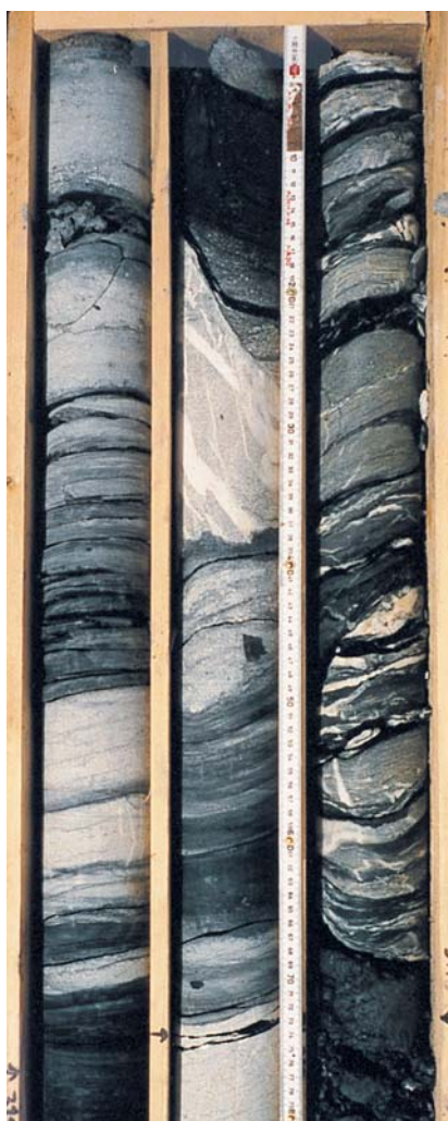
Les carottes d'un forage de reconnaissance renseignent les géologues sur la composition du sous-sol.
