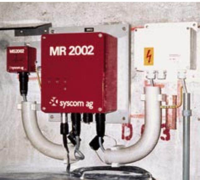
**Même le bassin versant de la retenue est régulièrement surveillé, pour parer à toute chute de rochers (en haut). Des instruments de mesures enregistrent les secousses sismiques au barrage de Mauvoisin (en bas).**
