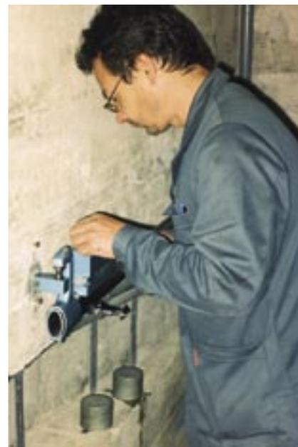
**Surveillance minutieuse des barrages: contrôle des déformations du barrage-poids de la Grande Dixence VS (à gauche), mesure de l'eau d'infiltration au barrage d'Isel GR (au milieu) et surveillance des mesures d'inclinaison au barrage de Molina GR (à droite).**
