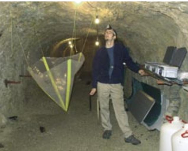
**Coloration d'une rivière et enregistrement du traceur infiltré dans le sous-sol.**
