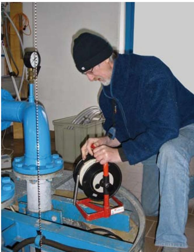
Mesure du niveau des eaux souterraines dans une station de pompage au Tessin.
