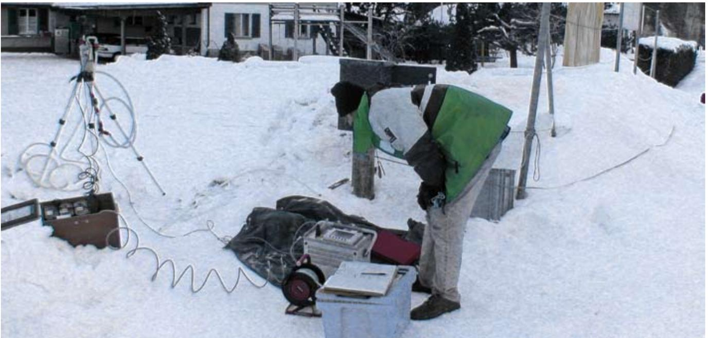
*Prélèvement d'échantillons dans l'une des 590 stations NAQUA, située dans l'Emmental.*
