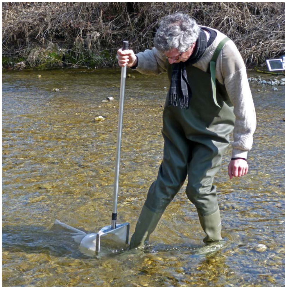
Fig. 25 > Prélèvement de macrozoobenthos au moyen d'un filet kicknet
