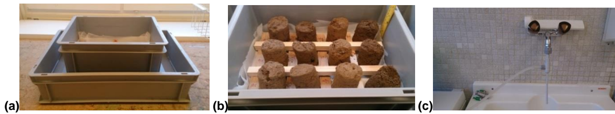
Figure 5: Dispositif d'humectation des échantillons de sol non remaniés : (a) bassines d'humidification des échantillons, (b) échantillons en phase d'humidification, (c) trompe à eau pour créer le vide dans la poche plastique.
