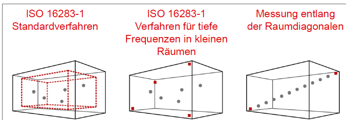
Abbildung 1: Schematische Darstellung der drei experimentell untersuchten Abtast- und Mittelungsverfahren
