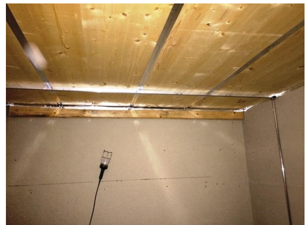
Abbildung 6: Realisierte mechanische Vorrichtung, um Schallfeld im Raum effizient in feinem Raster messtechnisch erfassen zu können
