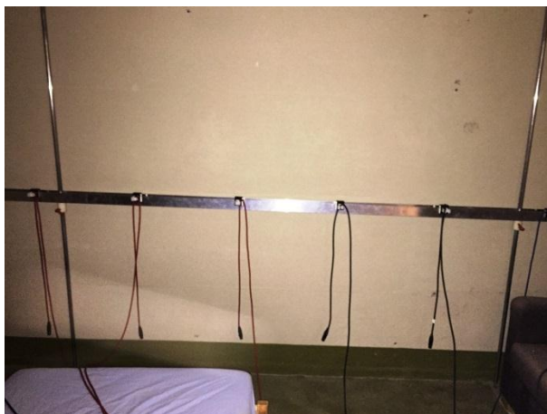
Abbildung 6: Realisierte mechanische Vorrichtung, um Schallfeld im Raum effizient in feinem Raster messtechnisch erfassen zu können
