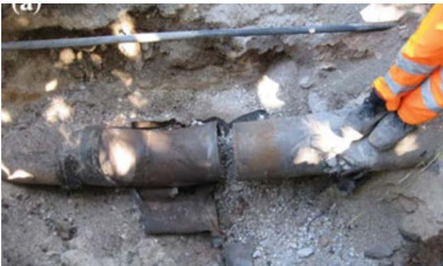
Rupture d'une conduite de gaz (L'Aquila, 2009)<sup>3</sup>
