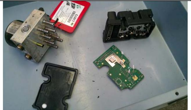
ABS-Modul (Steuergerät, Hydraulikeinheit), zerlegt
