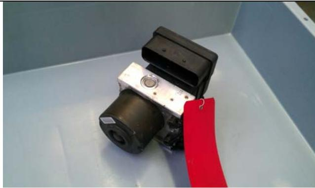
ABS-Modul (Steuergerät, Hydraulikeinheit), unzerlegt
